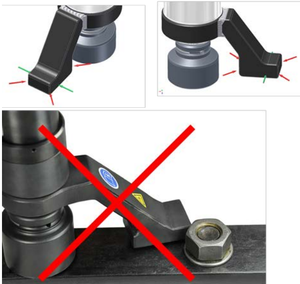
Falsche Abstützung an der Ecke des Fußes.
