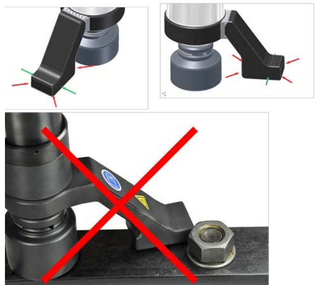
Apoyo incorrecto en la esquina del pie.
