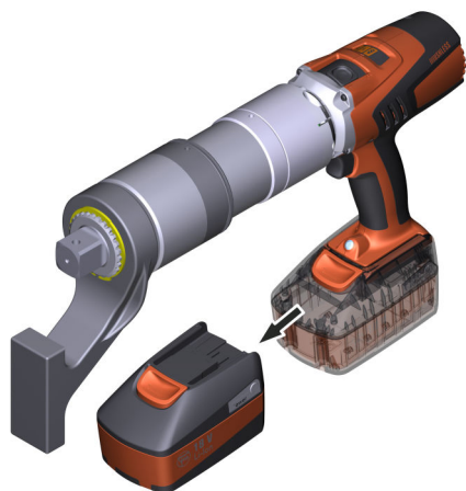
Fig. 27: rimozione della batteria
