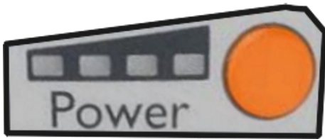
Fig. 10: indicatore a LED e tasto dell'indicazione del livello di carica
