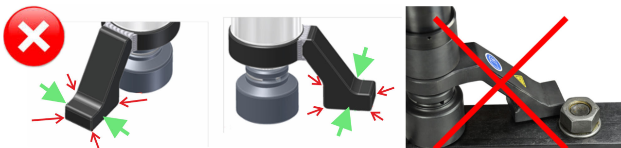
Fig. 20: appoggio sbagliato del braccio di reazione
