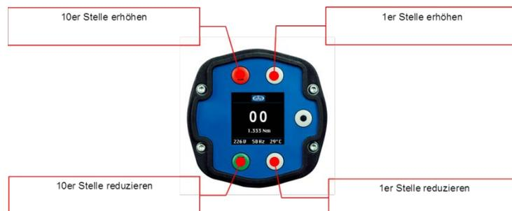
Impostare il momento torcente per ogni caso di avvitiamento sul valore desiderato. Controllare il momento torcente raggiunto sul caso di avvitiamento concreto prima di serrare tutte le viti di un caso di avvitiamento identico. Utilizzare per il controllo preferibilmente un trasduttore elettronico rotante. Si può tuttavia utilizzare anche una chiave dinamometrica collaudata. In caso di necessità, richiedere la nostra offerta sui dispositivi di misurazione del momento torcente.
