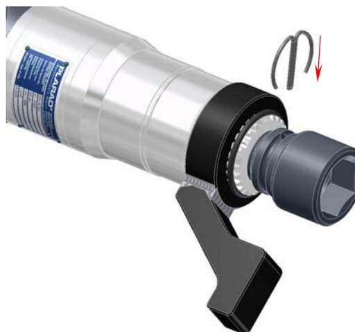
Avvitatore dinamometrico con sostegno bloccato e inserto a bussola bloccato.
