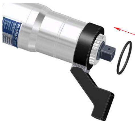
3. Inserire l'inserto a bussola sul quadro d'attacco d'uscita dell'avvitatore e bloccarlo. Utilizzate unicamente degli inserti a bussola per avvitatori ad impulsi.
