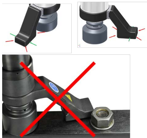
Sostegno errato sullo spigolo del piede.
