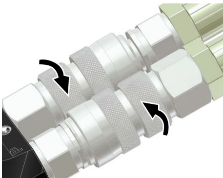
Afb. 23: Hydraulische aansluitingen borgen
