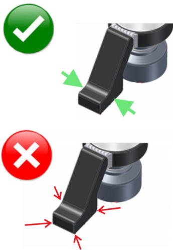
Fig. 14 : stabilisation correcte du bras de réaction
