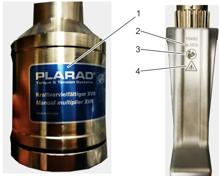
Fig. 12 : symboles apposés sur le multiplicateur de couple et le bras de réaction
