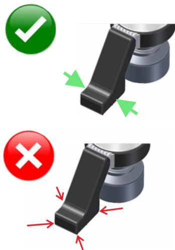
Fig. 14: Apoyar correctamente el brazo de reacción
