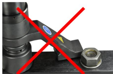
*Fig. 16 : mauvaise stabilisation du bras de réaction*
