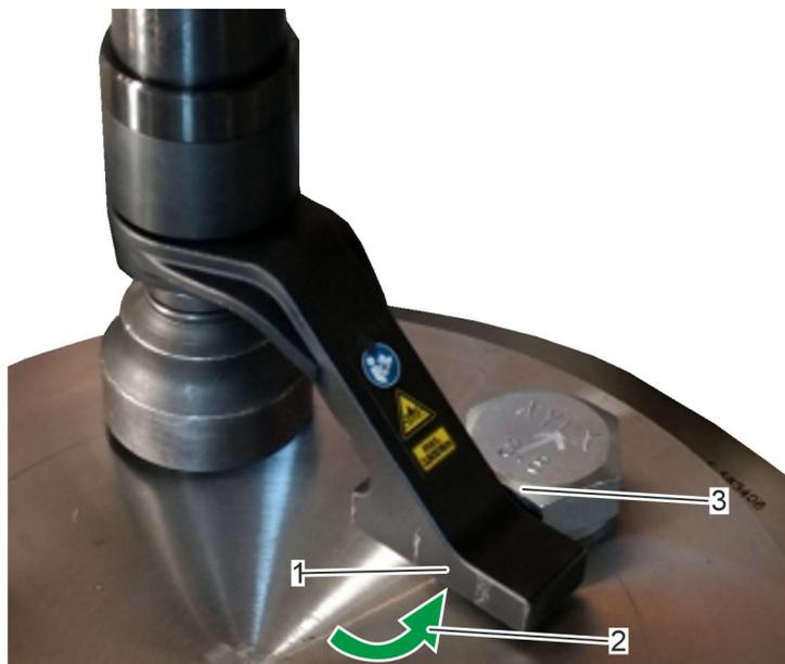
*Fig. 15 : stabilisation correcte du bras de réaction*
