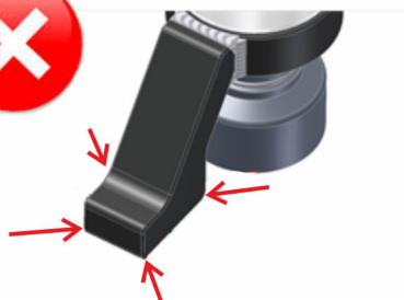
Fig. 19: Forkert støttet reaktionsarm
