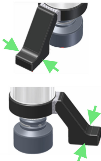
Fig. 18: Korrekt støtte af reaktionsarmen
