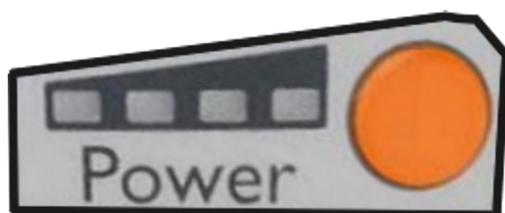
Abb. 14: LED-Anzeige und Taste Ladestandsanzeige
