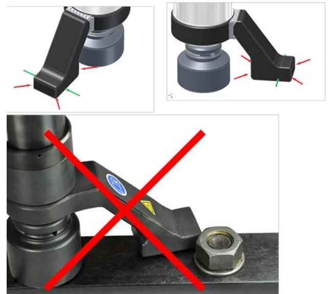
Falsche Abstützung an der Ecke des Fußes.
