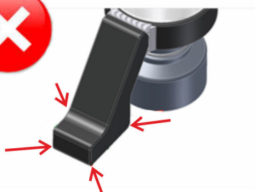
Abb. 16: Reaktionsarm falsch abgestützt
