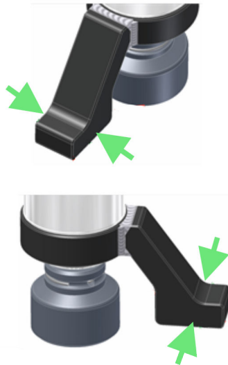
Abb. 15: Reaktionsarm richtig abstützen
