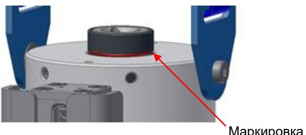
Достижение максимального хода обозначается красной маркировкой на стяжном болте. Если видна маркировка, следует приложить гайку и повторить процесс зажима после втягивания стяжного болта.
