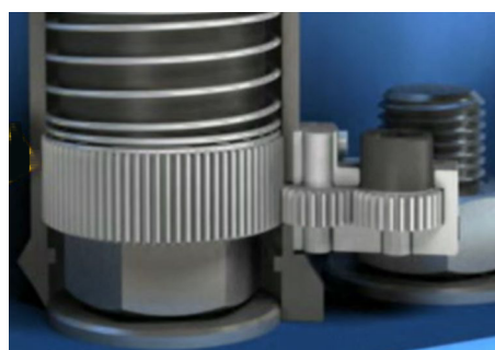
Рис. 39: Гайка не соосна
