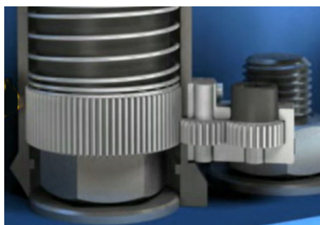
Рис. 27: Гайка не соосна
