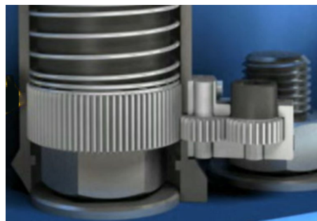
Рис. 34: Гайка не соосна
