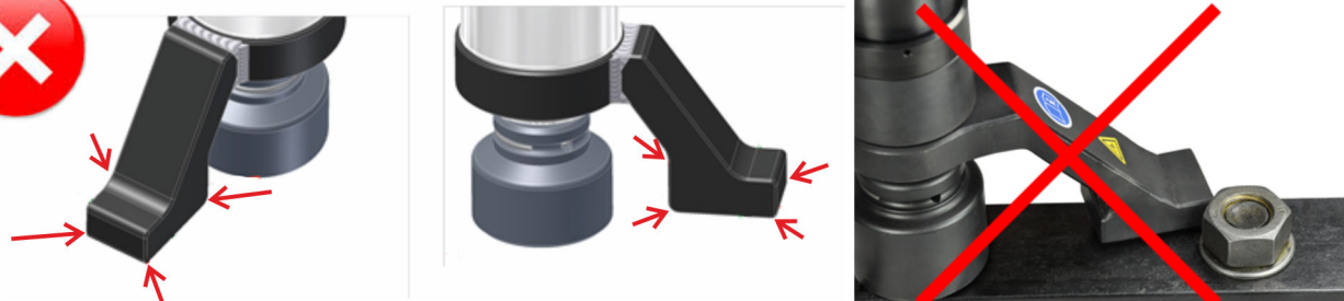
Fig. 16: appoggio sbagliato del braccio di reazione
