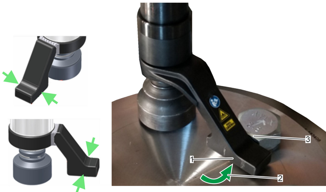
Fig. 15: appoggio corretto del braccio di reazione
