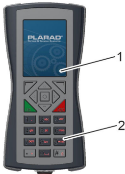
Рис. 9: Панель управления (BE)
