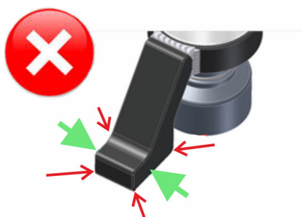
Obr. 20: Nesprávně opřené reakční rameno
