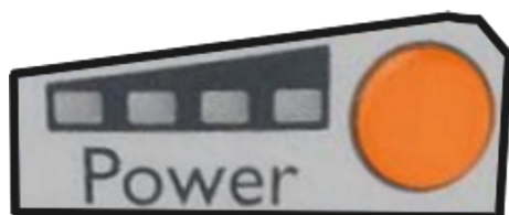
Fig. 12: Indicador LED y botón indicador del nivel de carga
