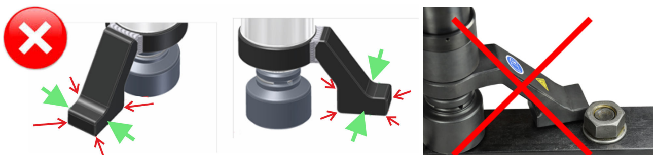
Fig. 24: Brazo de reacción mal apoyado
