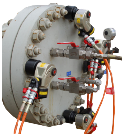
Fig. 29 : Exemple de vissage multiple
