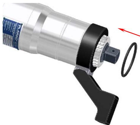
8. Steckschlüsseinsatz (Nuss) auf Abtriebs-Vierkant am Schrauber aufstecken und sichern. Verwenden Sie ausschließlich Kraftsteckschlüsseinsätze.
