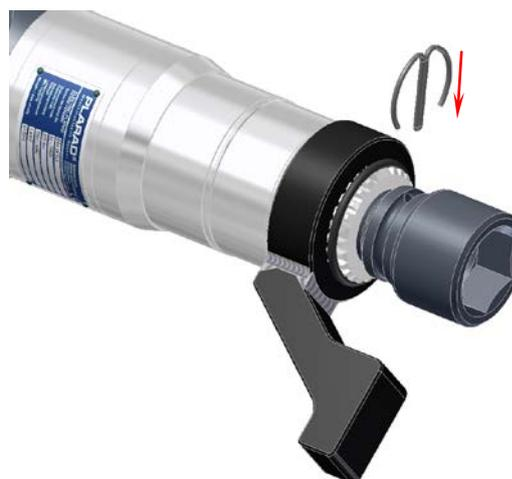
Drehschrauber mit gesicherter Abstützung und gesichertem Kraftsteckschlüsseinsatz.
