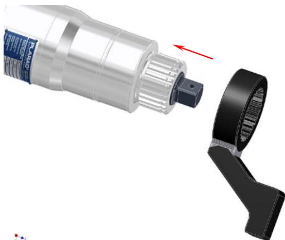
7. Abstützung mit Sicherungsring sichern.
